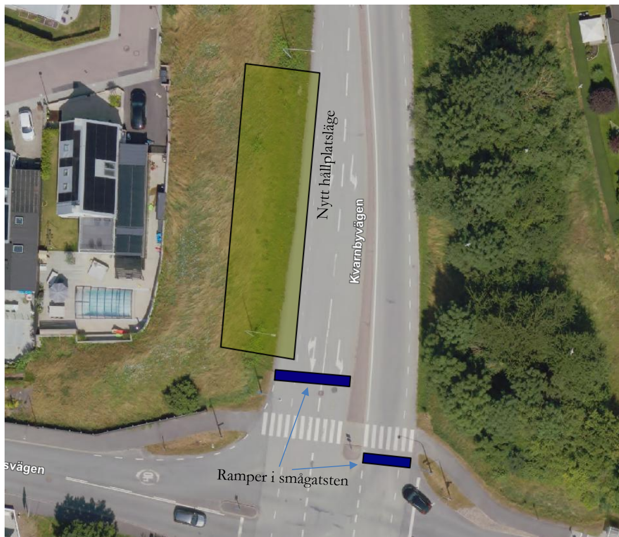
Princip för hastighetsdämpande åtgärder
