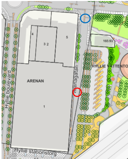
Befintligt övergångsställe markerat med blått och nytt övergångsställe markerat med rött
