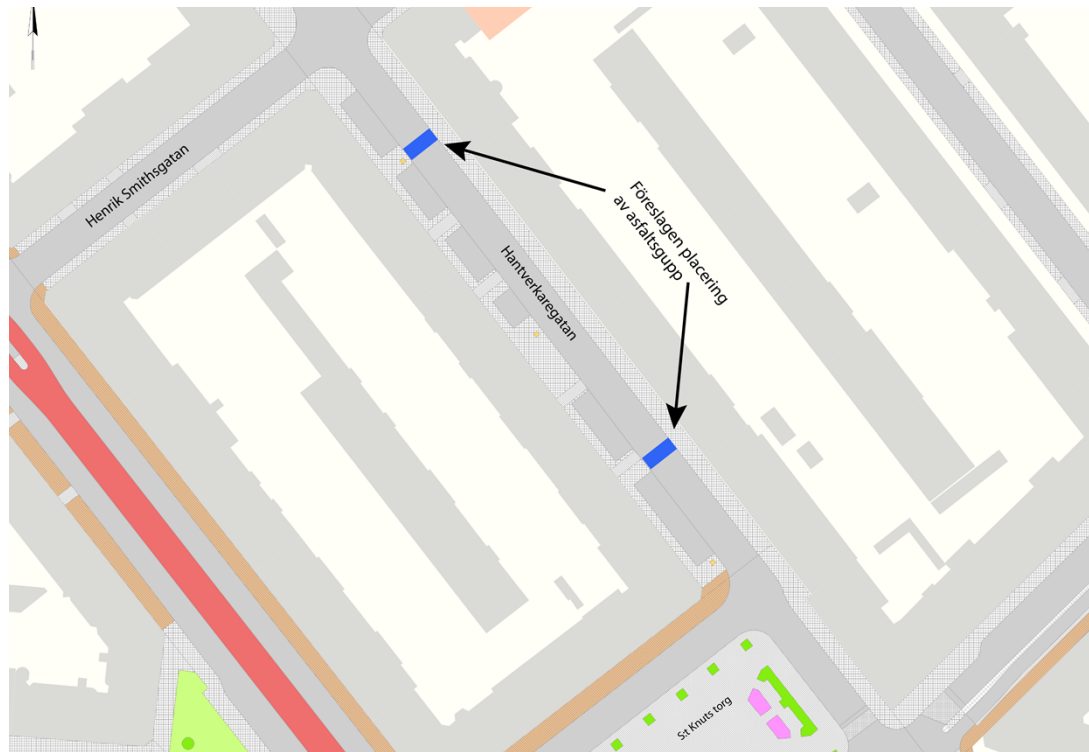
Figur 4. Placering av asfaltsgupp på Hantverkaregatan.
