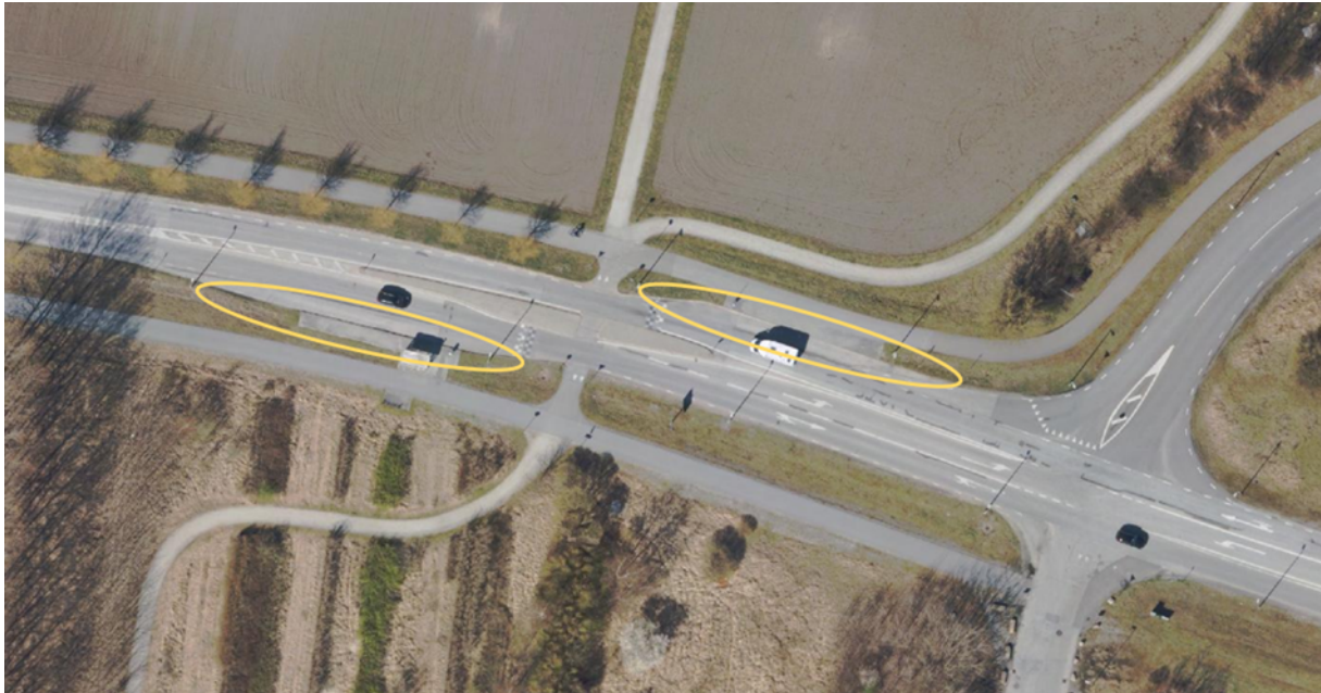
Figur 2. Gottorpsvägen väster om Lorensborgsgatan. Befintliga hållplatser som åtgärdas. Mellanliggande gångpassage föreslås regleras med övergångsställe. Hastigheten föreslås sänkas till 40 km per timme.
