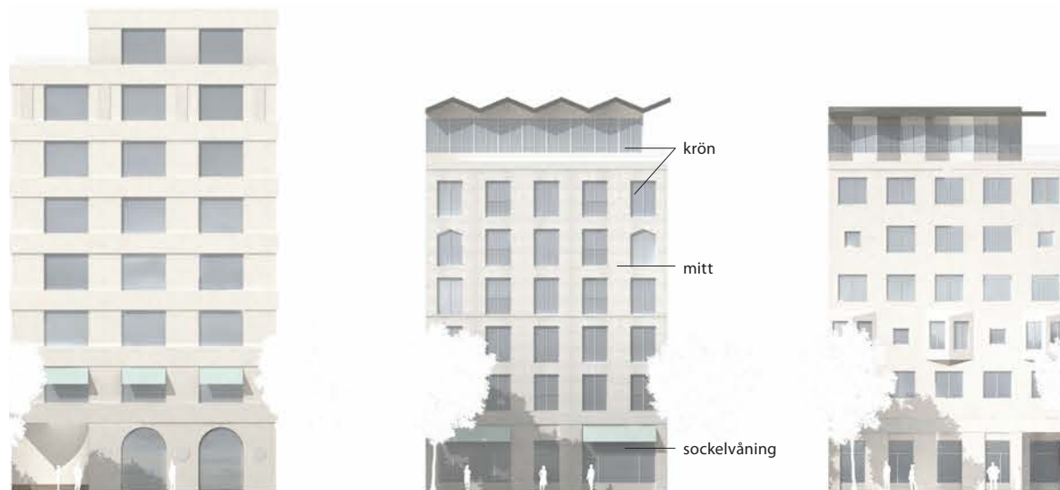
Exempel på fasader med tydlig indelning i sockelvåning, mitt och krön.
