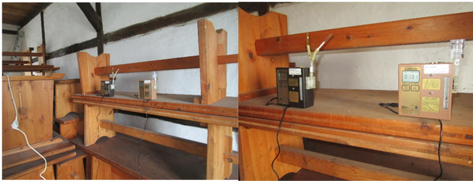
Figur 2. Luftprovtagning med luftpumpar och absorbenter samt filter.
