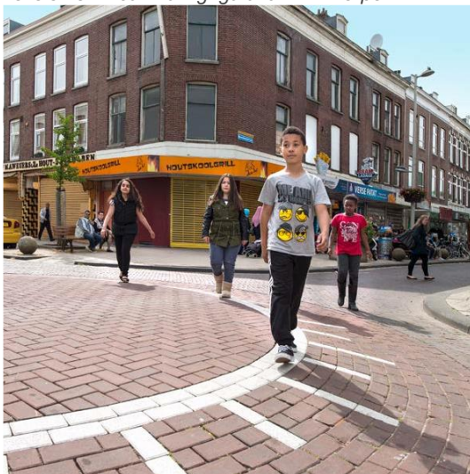
Korsningarna i de barnvänliga gatunäten har en speciell hastighetsdämpande utformning som liknar huvudet på ett häftstift. Foto: Myléne Siegers Fotografie, 2013.
