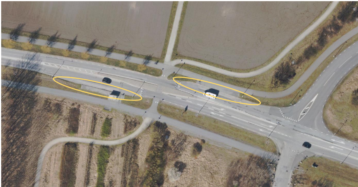
Figur 1 Gottorpsvägen väster om Lorensborgsgatan. Befintliga hållplatser som åtgärdas. Mellanliggande gångpassage föreslås regleras med övergångsställe. Hastigheten föreslås sänkas till 40 km per timme.
