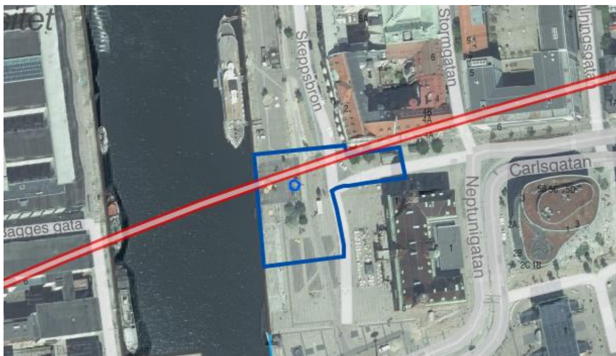
Figur 115. Planerad sträckning för avloppstunneln i anslutning till utredningsområdet. Tunnelns sträckning i rött, anslutningschakt som blå cirkel och arbetsområde, inklusive område för ledningsomläggningar i blått.
