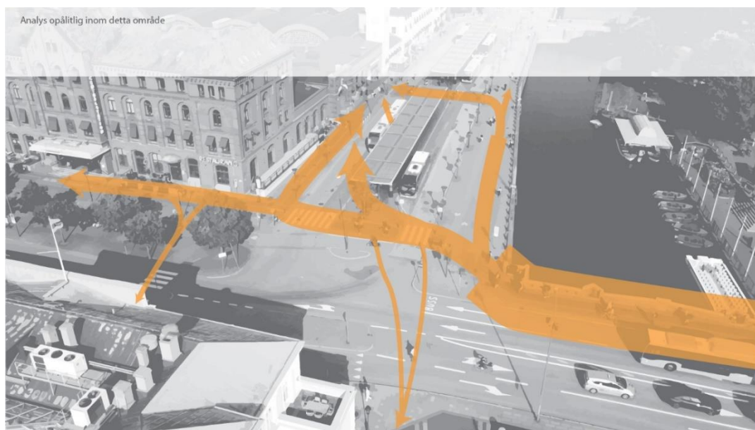
Figur 89. Fotgängarströmmar sydväst om centralen. Filmanalysen bedömdes inte ge en korrekt bild av rörelserna i det övre området i bilden, till följd av bland annat skymmande skärmtak och svårigheter att skilja cyklister från gående.
