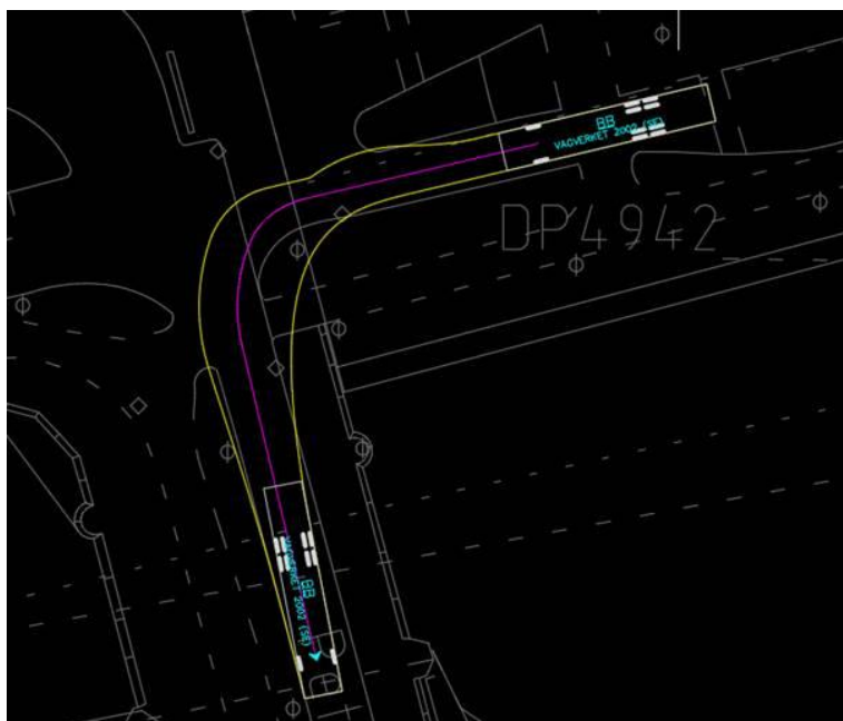
Figur 55. Körsår för boggibuss som svänger vänster från Centralplan söderut på Petribron.
