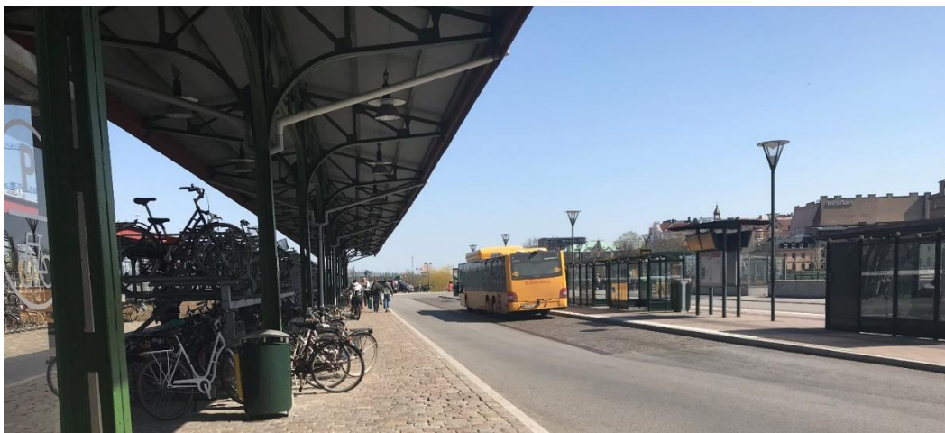
Figur 38. Gångytan på Centralplan nordvästra har en ojämn beläggning med storgatsten samt är smal, särskilt då ytan ofta används för spontan uppställning av cyklar.
