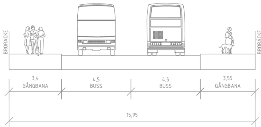
Figur 43. Befintlig sektion Centralbron
