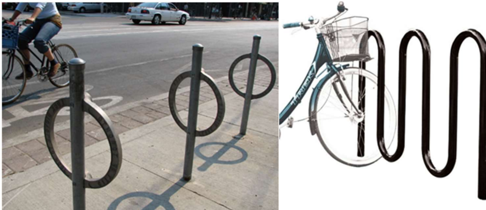
Figur 9. Exempel på cykelparkering med ramlåsning.
