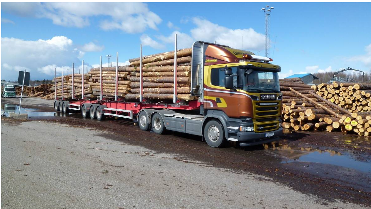
Figur 1 Ett virkesfordon vars bruttovikt får uppgå till 74 ton. Notera att fordonståget har fyra travar, jämfört med tre travar för ett 64-tonsfordon. Foto: Caroline Lombardini
