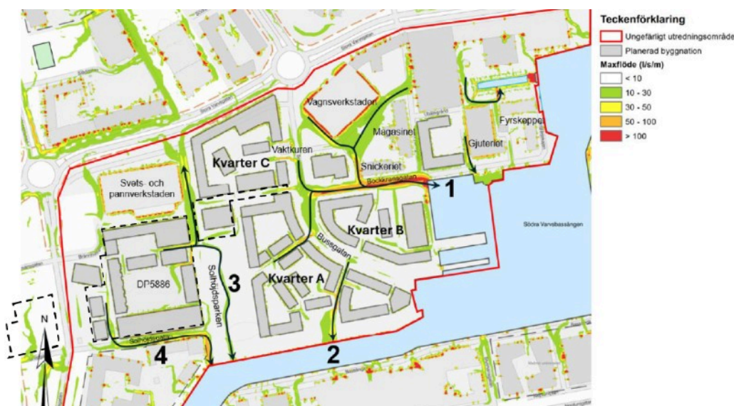
Maximala vattenflöden (l/s/m) för framtida höjdsättning under simulerat 100-årsregn. Primära flödesvägar inom området numrerade 1-4. Planområdet inom svartstreckade linjer. Källa: Norconsult
