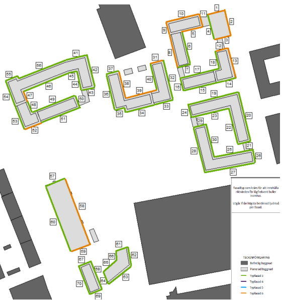
Typfasader som krävs för att klara Folkhälsomyndighetens riktvärden för lågfrekvent buller (Efterklang, 2025).
