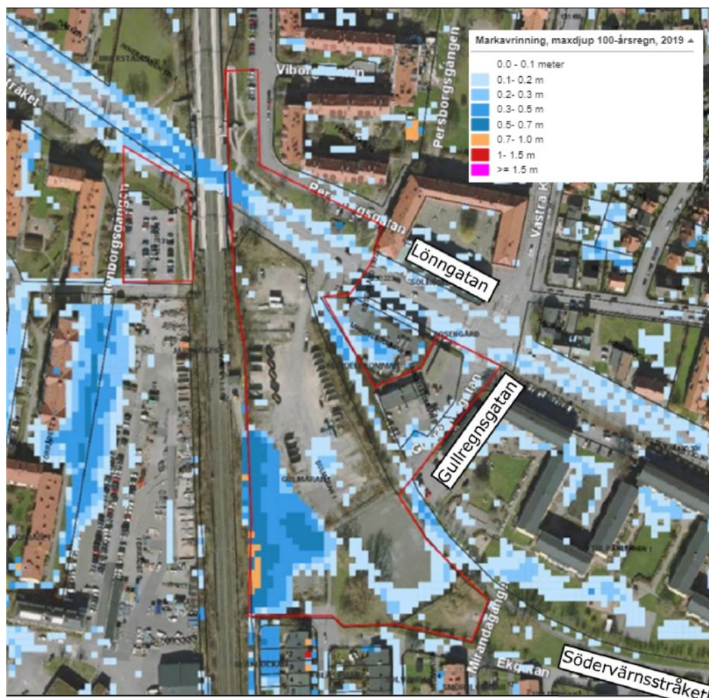
Figur som visar skyfallskartering med maxdjup vid 100-årsregn, befintlig situation 2019. Röd linje är utredningsområde i utredningen. Afry, 2023.
