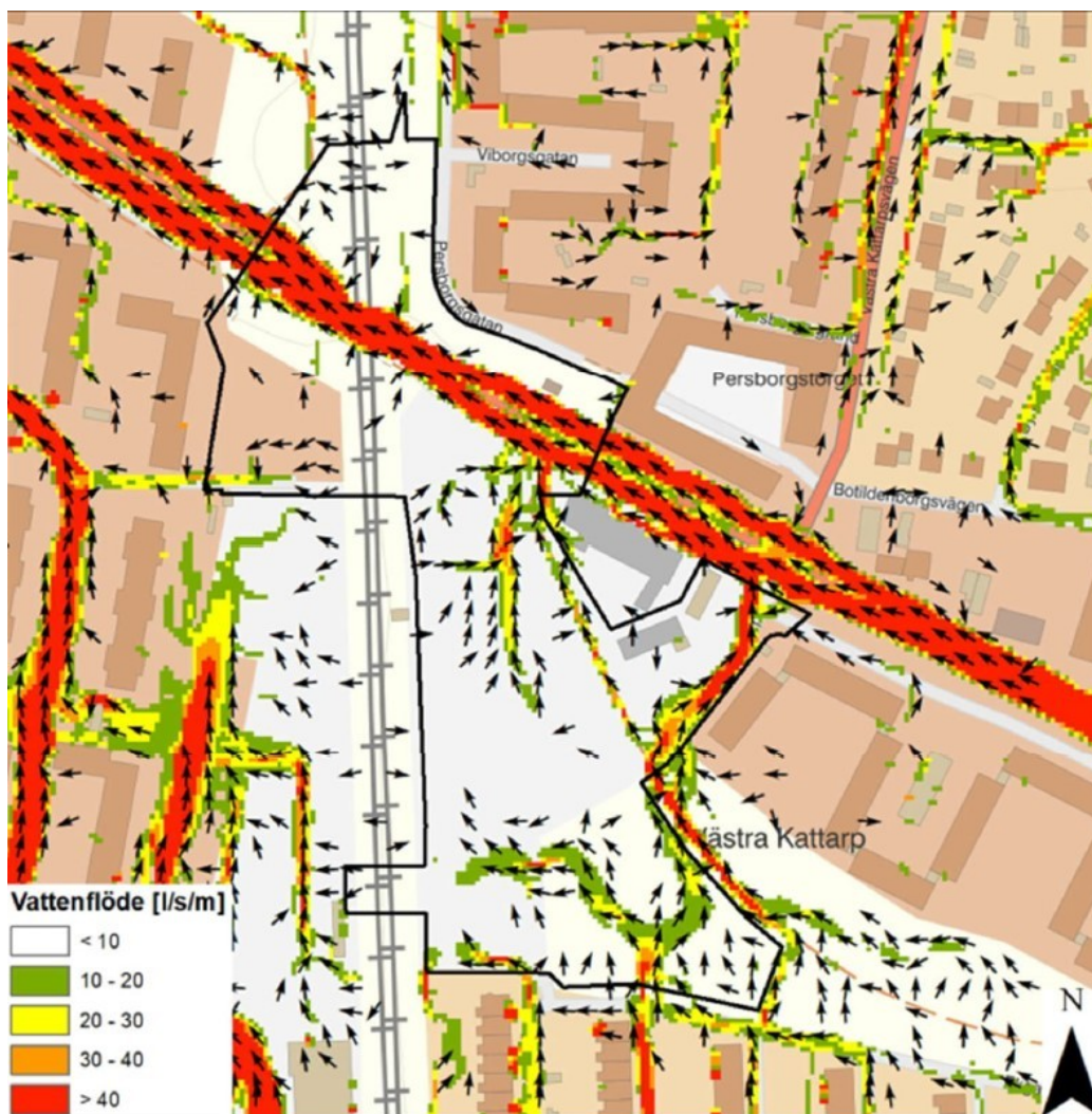
Figur som visar vattenflöden inom området. Flödesriktningarna gäller cirka 30 minuter efter intensitetstoppen av skyfallet (100-årsregn). Svart linje är utredningsområde i utredningen. Afry, 2023.
