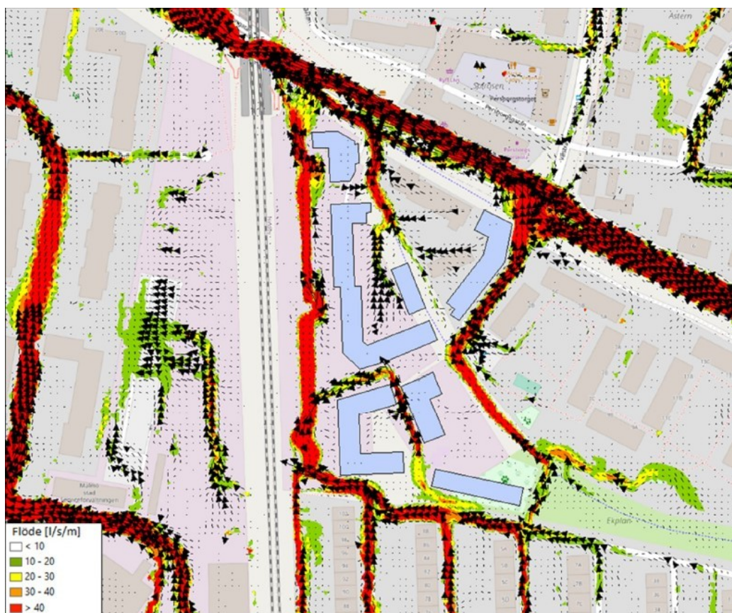
Figur som visar strömningsriktningar 20 minuter efter intensitetsmaximum. Afry, 2023.
