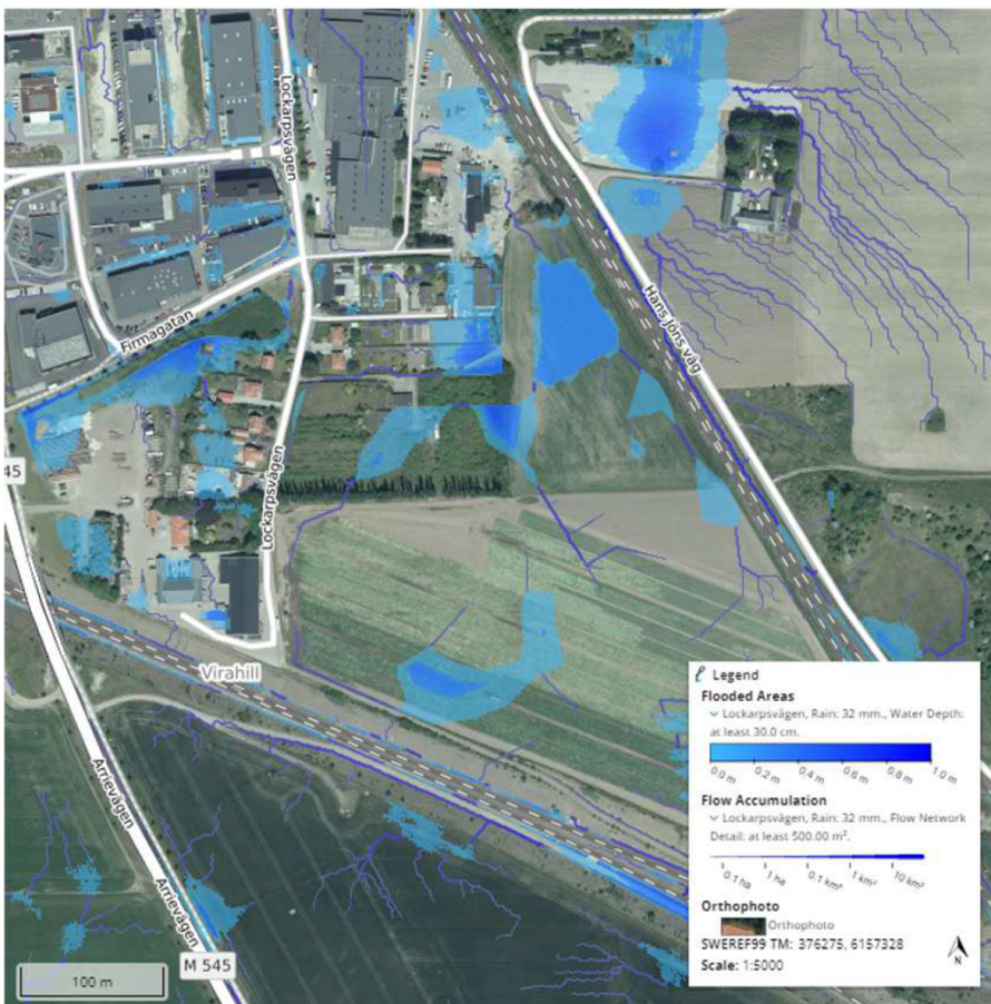
Figur 11 Rinnvägar och lägpunkter vid framtida förhållanden mot ortofoto, enligt analys i Scalgo.
