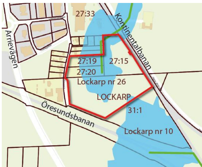
Figur 30 Dikningsföretagen Lockarp nr 26 och Lockarp nr 10. Diken visas som gröna linjer. Båtnadsområden visas som blå ytor. Planområdeseränserna visas som röd
