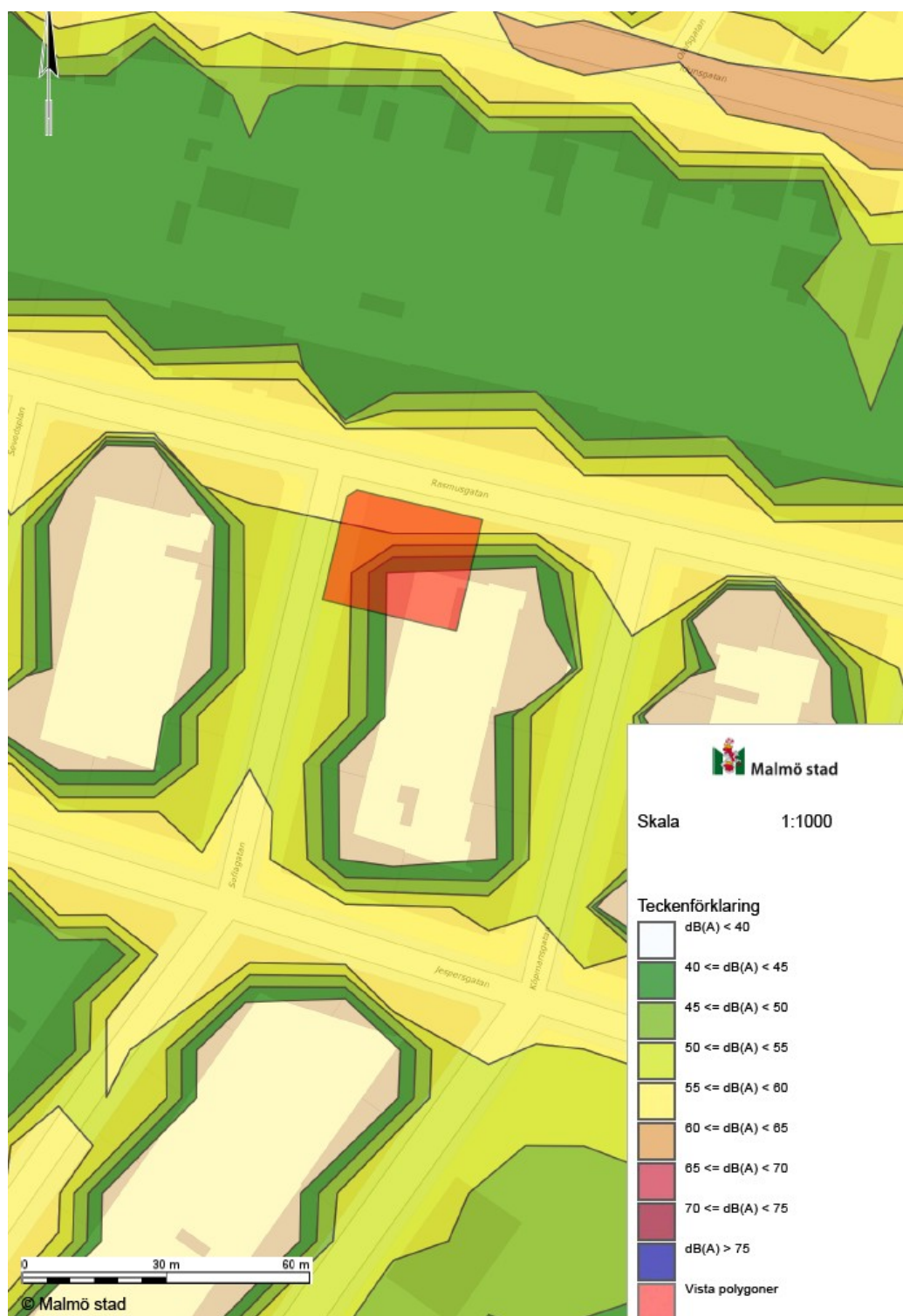
Figur 5. Beräknade ekvivalenta bullernivåer från väg (dBA) 2 meter ovan mark. Ekvivalenta nivåer innebär medelljudnivåer. Ytorna är förenklade. Område som berörs av ändring av detaljplan är markerat i rött. Källa: Miljöförvaltningen, Malmö stad (2021).
