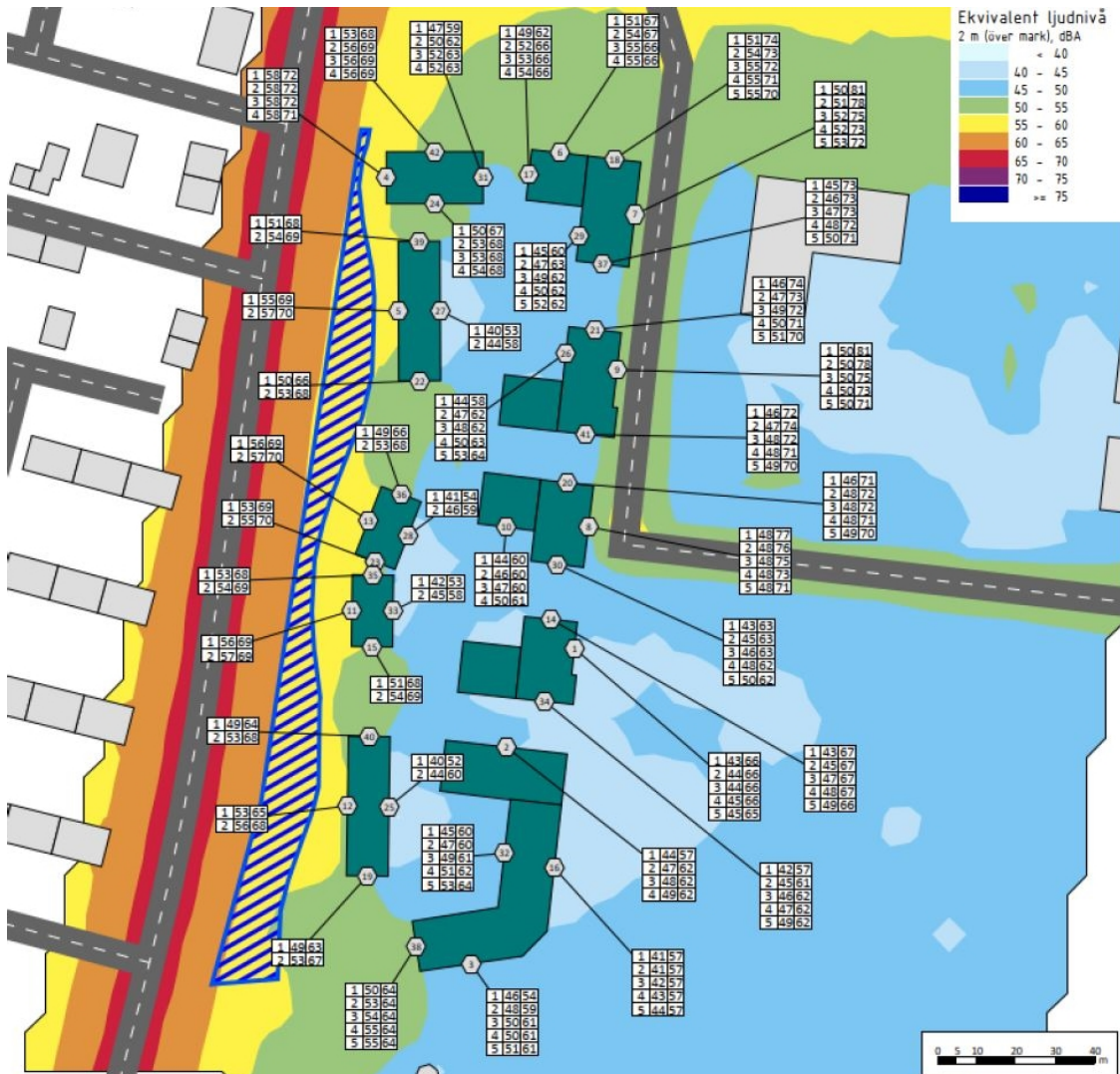
Kartan visar planrådets beräknade ljudnivåer vid fasad från trafik prognosår 2040. Tabellernas första kolumn visar våningen, andra kolumnen visar ekvivalent ljudnivå och tredje kolumnen visar maximal ljudnivå.
