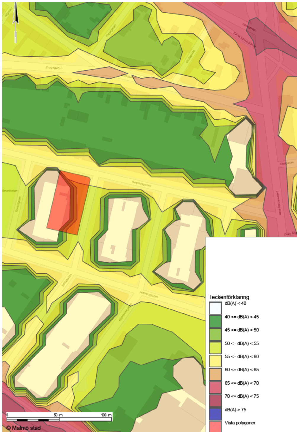
Figur 4. Beräknade ekvivalenta bullernivåer från väg (dB(A)) 2 meter ovan mark. Ekvivalenta nivåer innebär medelljudnivåer. Ytorna är förenklade. Planområdet är markerat i rött. Källa: Miljöförvaltningen, Malmö stad (2021).
