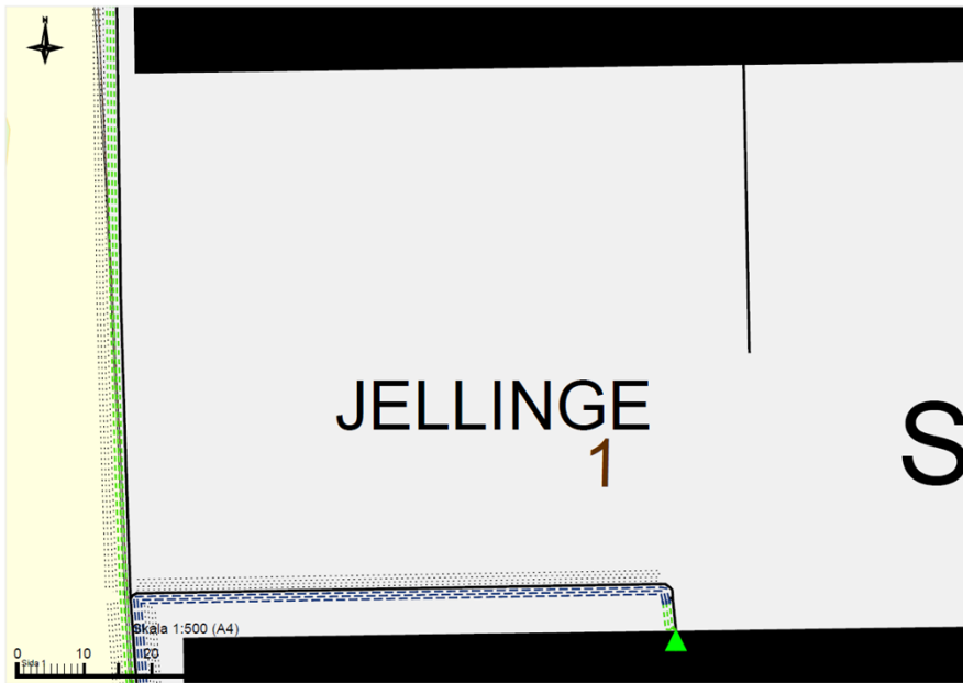
Figur 3. Bild hämtad från yttrande. Markförlagda lågspänningskablar i osäkert läge.
