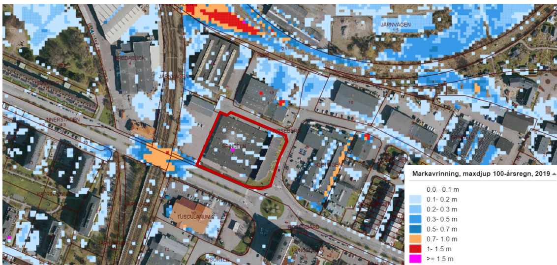
Utdrag ur Malmö stads skyfalls-simulering som redogör för maxdjup vid 100-årsregn.
