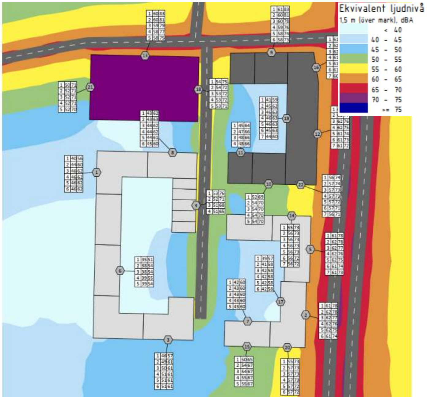
Vägtrafikbuller, maximal ljudnivå, trafikprognos 2040, beräkningshöjd: 1,5 m ovan markytan. Lila byggnad är p-bus, mörkgrå är kontor och ljusgrå är bostäder. Tabellerade värden avser frifältsvärden och avläses "Våning / Leq / Lmax".
