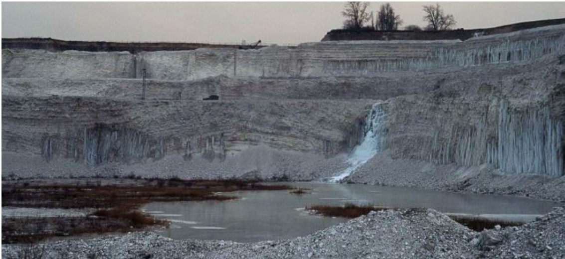
Figur 29. Äldre bild i Limhamns kalkbrott där inflödande grundvatten har frusit till is. Bild från Ingenjörsgelogisk kartering (COWI, 2021).
