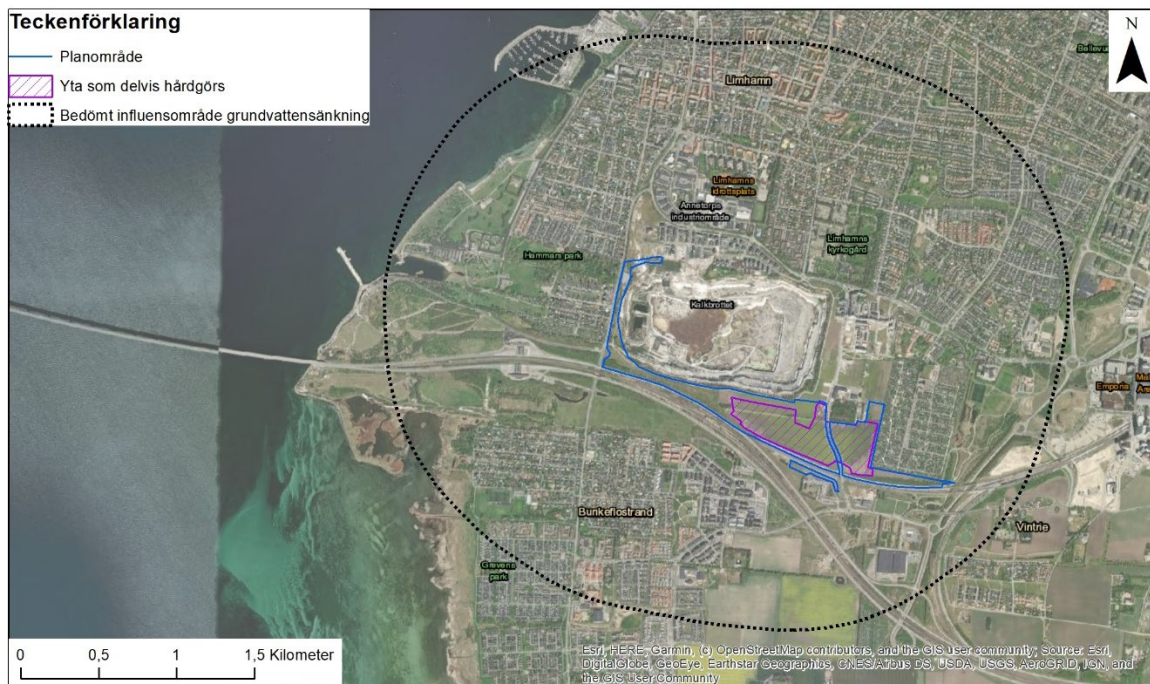
Figur 32. Bedömd avsänkningstratt/influensområde vid pågående läns hållning i kalkbrottet (svart cirkel). Influensområdet bedöms översiktligt ha en radie på 1,5 kilometer från kalkbrottet och baseras på mängden inläckande vatten, bedömd hydraulisk konduktivitet i berget, avsänkingsnivå och bedömd grundvattenbildning i området. Den yta som planeras bebyggas inom planområdet redovisas i lila.
