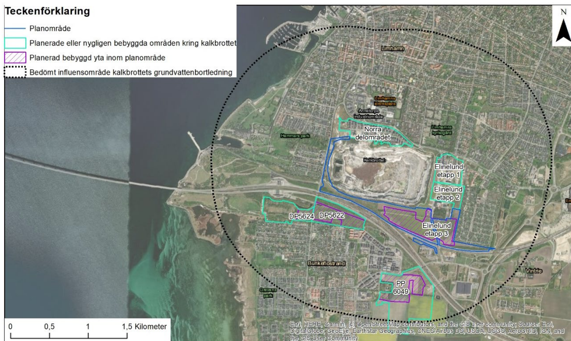
Figur 33. Bedömd avsänkningstratt/influensområde vid pågående länshållning i kalkbrottet (svart cirkel). Influensområdet bedöms översiktligt ha en radie på 1,5 kilometer från kalkbrottet och baseras på mängden inläckande vatten, bedömd hydraulisk konduktivitet i berget, avsänkingsnivå och bedömd grundvattenbildning i området. Den yta som planeras byggas inom planområdet redovisas i lila. De områden där kumulativa effekter beräknats framgår i turkos.
