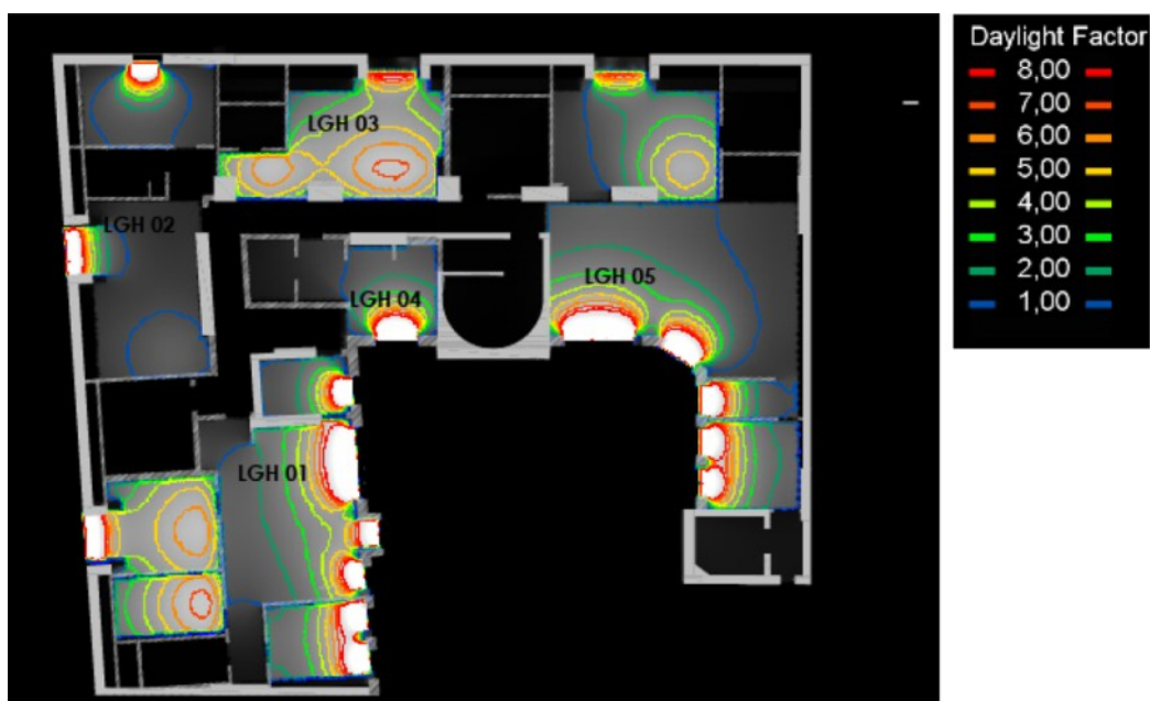
Figur 2. Dagsljussimulering av vindspanet (Intervall DF 1–2). En sämre dagsljusfaktor i lägenhet 02 beskrivs bero på att befintliga fönster mot gatan inte ändras. Inflödet av ljus påverkas av takvinkeln samt av att befintlig konstruktion hindrar möjligheten till takfönster. För att komplettera dagsljuset i denna lägenhet föreslås exempelvis installation av en ljusstunnel (så kallad Solatube). Källa: Kamikaze Arkitekter, 2020-10-20.
