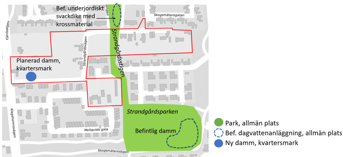
Illustration som visar befintliga ytor för dagvattenhantering i intilliggande parker, samt planerad damm på kvartersmark.
