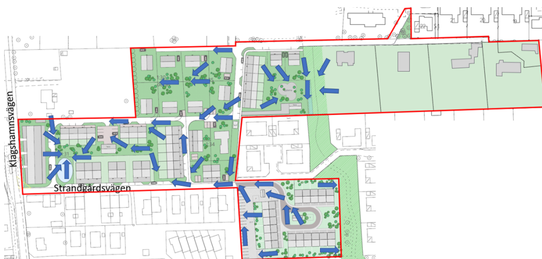
Skyfall planförslag: Förslag på rinnvägar när området är exploaterat, så att vattnet rör sig bort från byggnader, mot parkerings- och grönytor (Semrén Månsson och Malmö stad, 2022).
