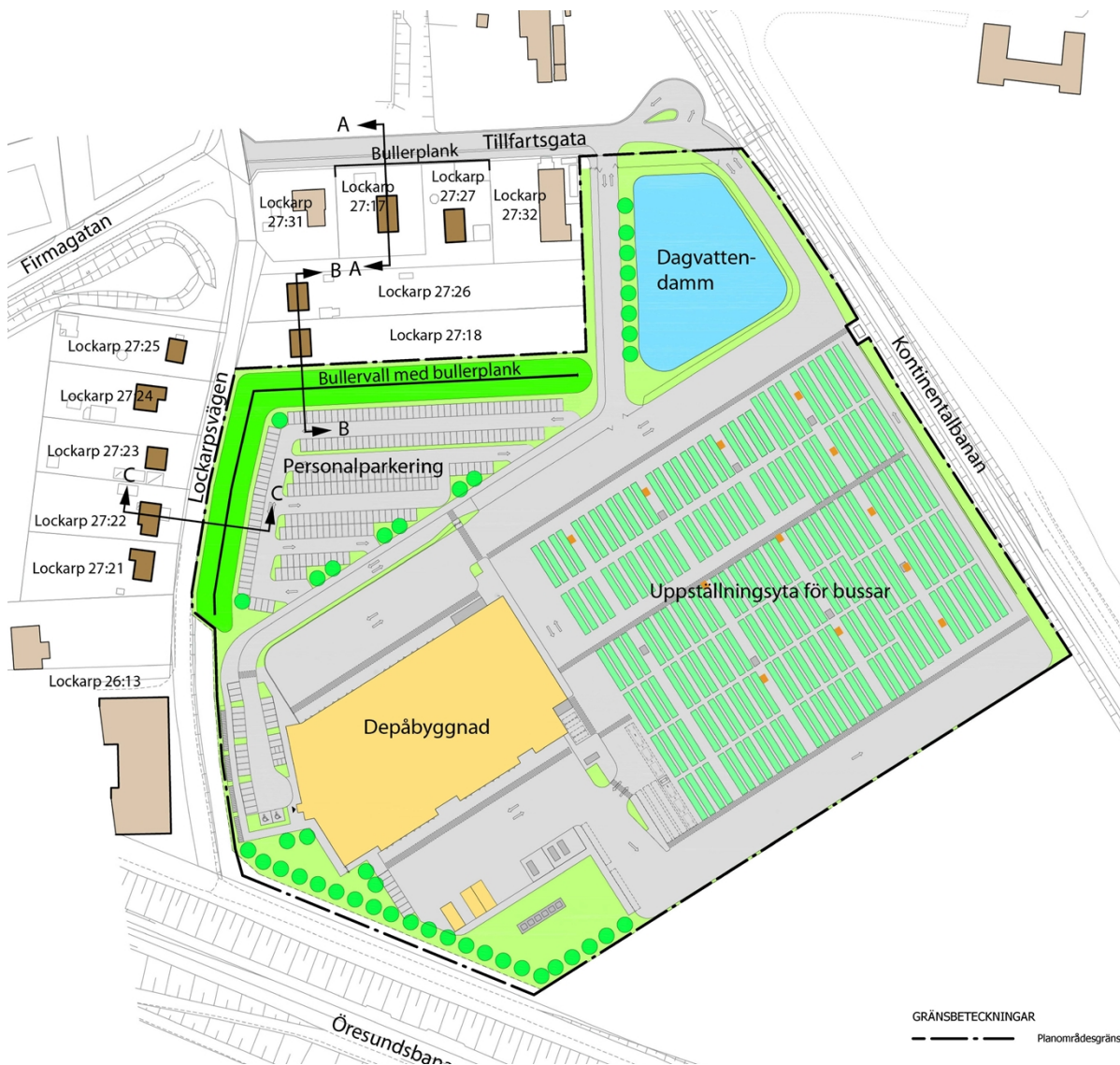
Figur 2 Illustrationsplan över möjlig utformning av bussdepå. Närliggande bostadshus är illustrerade i mörkbrunt. Bussdepåns huvudbyggnad är illustrerad i gult. Notera att tillfartsgatan inte tillhör detaljplaneområdet. Illustration: BBH Arkitektur och teknik och Stadsbyggnadskontoret
