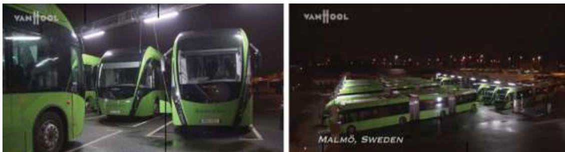
Figur 3 Exempel på bussar i depå. Ovanför bussarna löper mediabalkar som servar bussarna med bland annat elladdning
