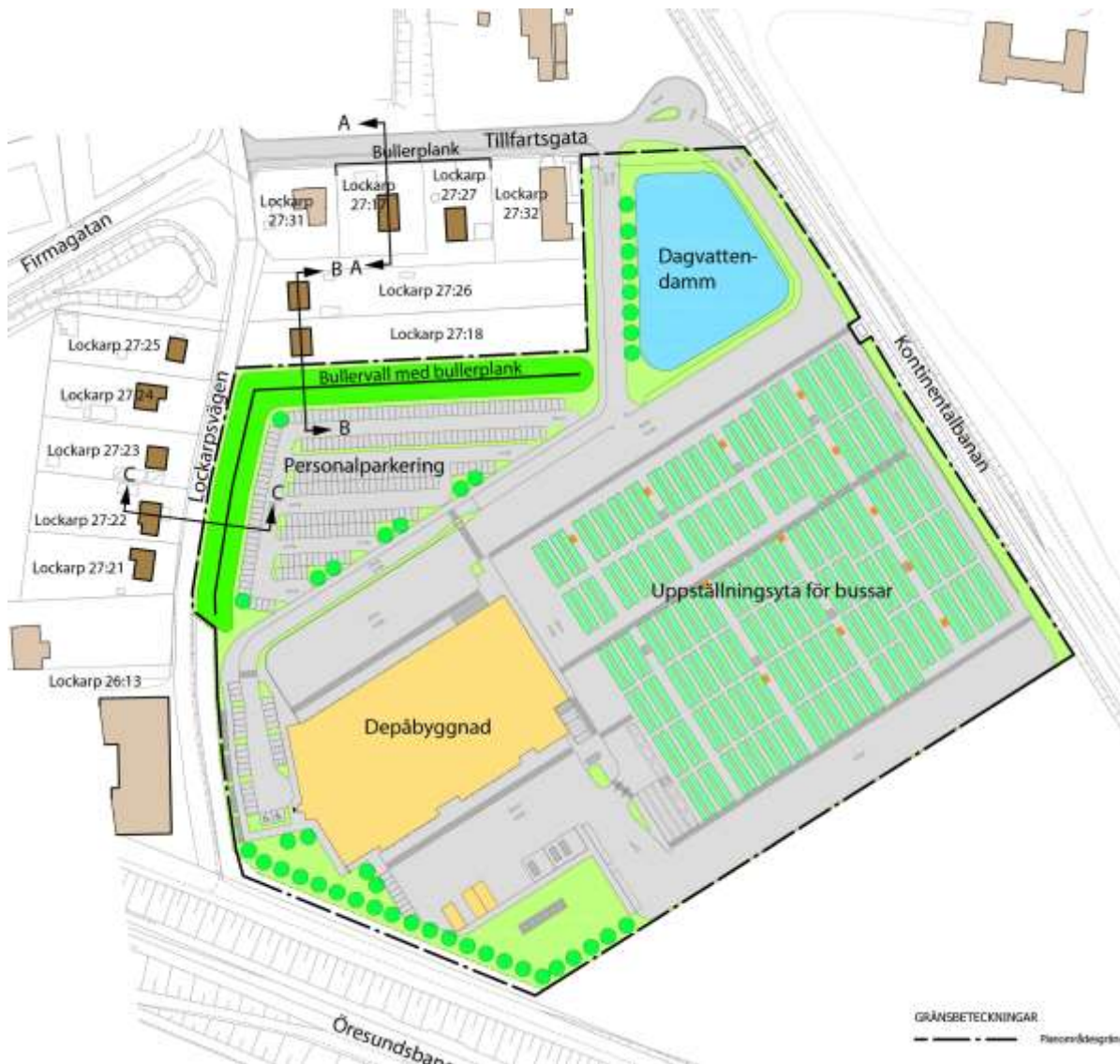
Figur 2 Illustrationsplan över möjlig utformning av bussdepå. Närliggande bostadshus är illustrerade i mörkbrunt. Bussdepåns huvudbyggnad är illustrerad i gult. Notera att tillfartsgatan inte tillhör detaljplanelområdet. Illustration: BBH Arkitektur och teknik och Stadsbyggnadskontoret
