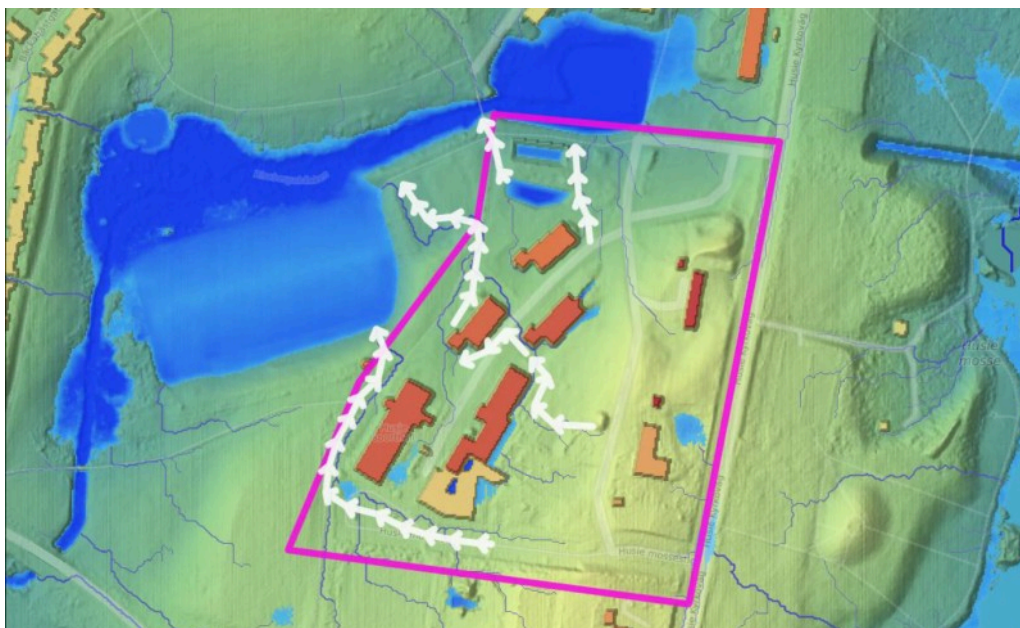
Figur som visar beräknade avrinningsvägar och lågpunkter vid ett klimatanpassat 100-årsregn efter planförslagets genomförande (BSV, 2026). Utredningsområdet markeras med lila linje. Vita pilar visar huvudsakliga avrinningsvägar och ljusblå ytor visar lågpunkter där vatten kan samlas. De föreslagna torrdammarna inom allmän plats i planområdets nordvästra del visas också som blå ytor.
