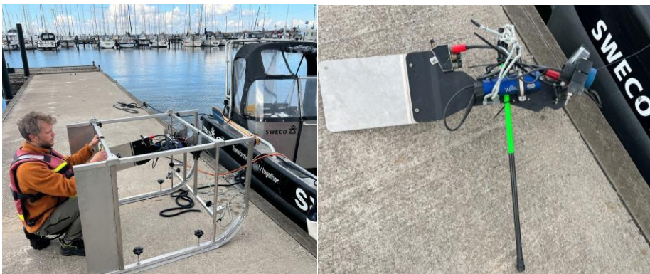
Figur 2 Kameraruppsättningar använda 2025. 1) Slädkonfiguration 2) friflygande med distansutskott. Båda system ger live-video upp i båt via undervattenskabel.
