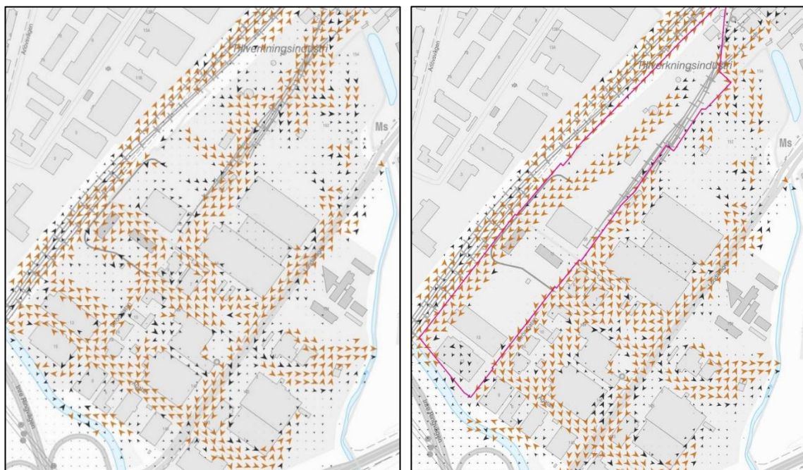
Figur 38. Figuren visar flödesriktning vid ett 100-årsregn (med klimatfaktor 1,3) över planområdena. Till vänster syns flödesriktning vid befintliga förhållanden, där flöden rinner genom planområdena. Till höger syns flödesriktning vid framtida förhållanden där markområdena inom planområdena har höjts till +3,43 (väg nedsänkt 0,2 meter). Källa: WSP, 2025b.
