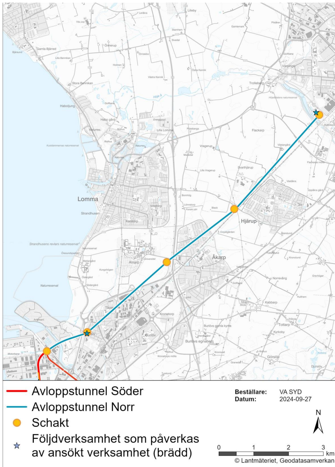
Figur 8-2 Påverkade bräddpunkter och följdverksamhet avseende ledningsnätet.
