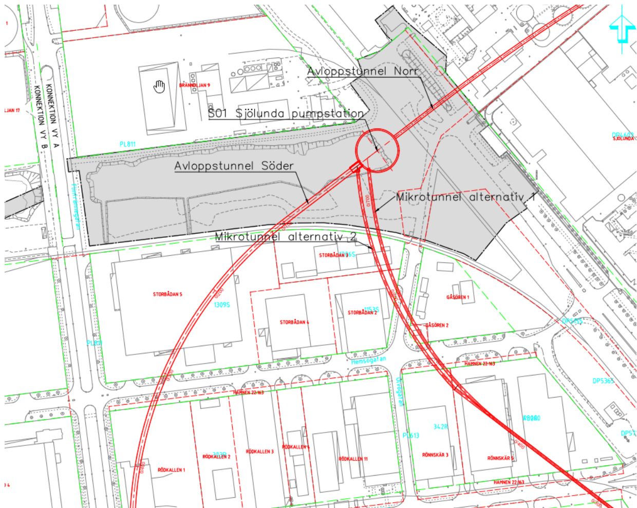
Figur 5-2. Illustration som redovisar mikrotunnelns alternativa anslutningar.
