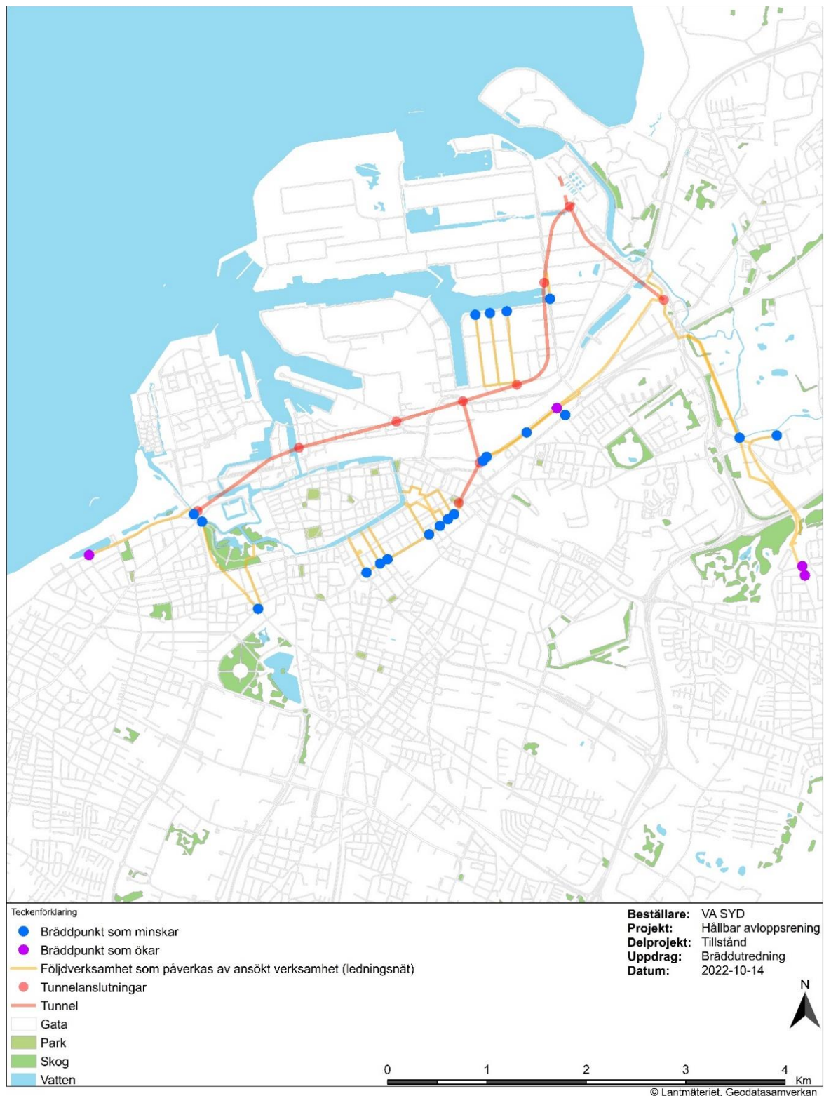
Figur 11 Påverkade bräddpunkter och följdverksamhet avseende ledningsnätet.
