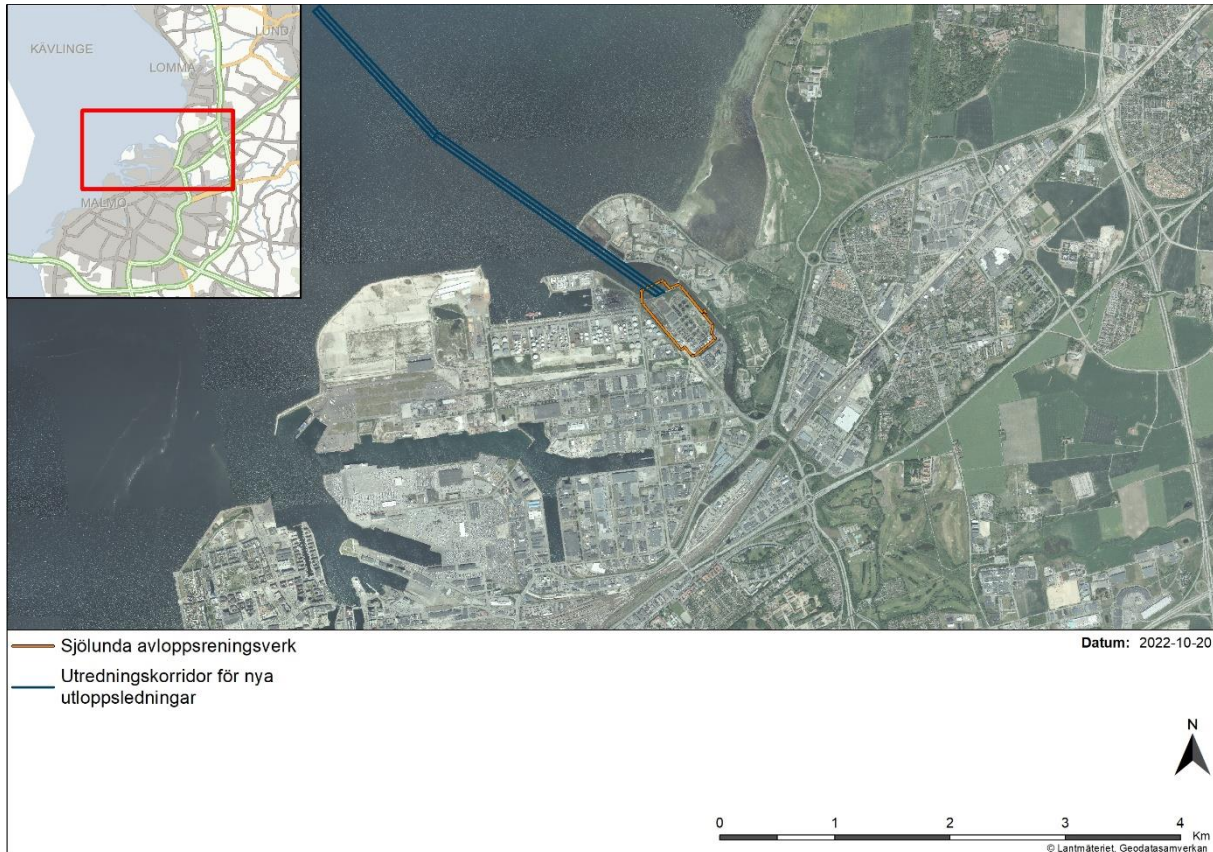
Figur 16 Om- och utbyggnaden av Sjölunda avloppsreningsverk sker vid den nuvarande lokaliseringen. Nya utloppsledningar planeras.
