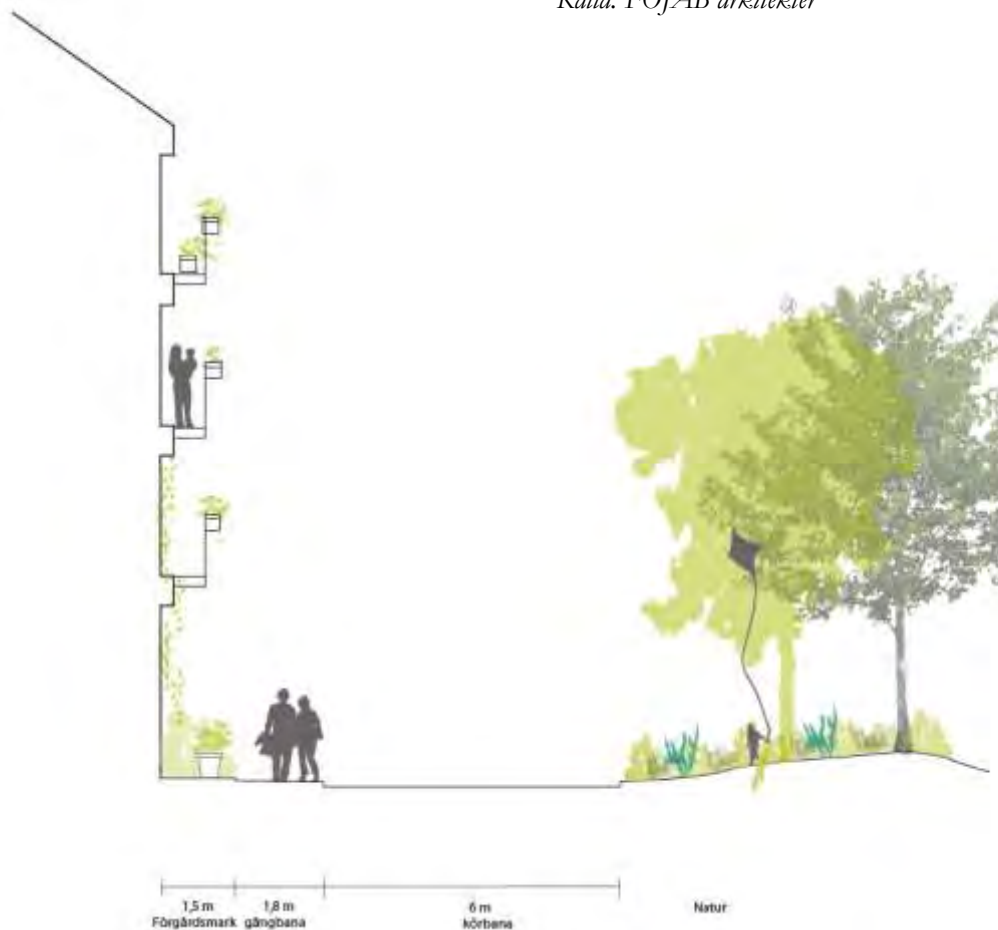
Gatusektionen ovan visar en princip över hur gatan i den norra delen av området ska se ut. Källa: FOJAB arkitekter (sektion 1 i kartan)
