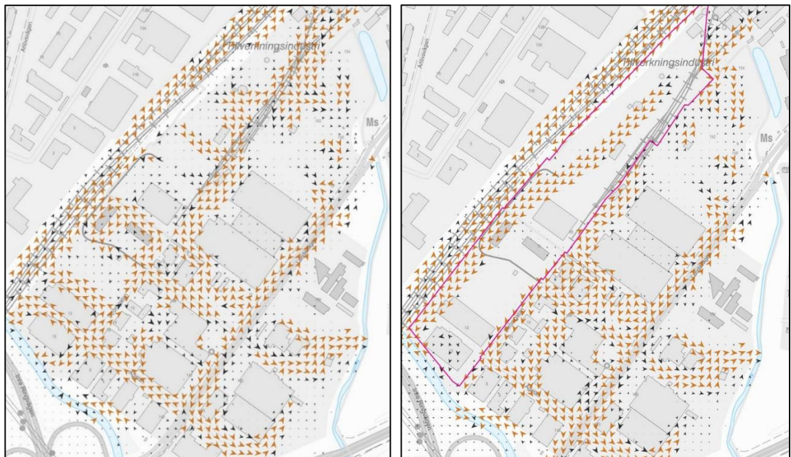
Figur 39. Figuren visar flödesriktning vid ett 100-årsregn (med klimatifaktor 1,3) över planområdena. Till vänster syns flödesriktning vid befintliga förhållanden, där flöden rinner genom planområdena. Till höger syns flödesriktning vid framtida förhållanden där markområdena inom planområdena har höjts till +3,43 (väg nedsänkt 0,2 meter). Källa: WSP, 2025b.
