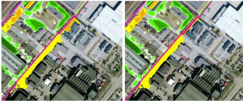
Figur 40. Förändring av maximalt vattendjup från befintliga till framtida förhållanden utan åtgärd (t.v.) och med åtgärd (t.h.). Minskning av vattendjup visas i gröna ytor. Ökning av vattendjup visas med gula (5-10 cm) och orange (>10 cm) ytor. Källa: WSP, 2025b.
