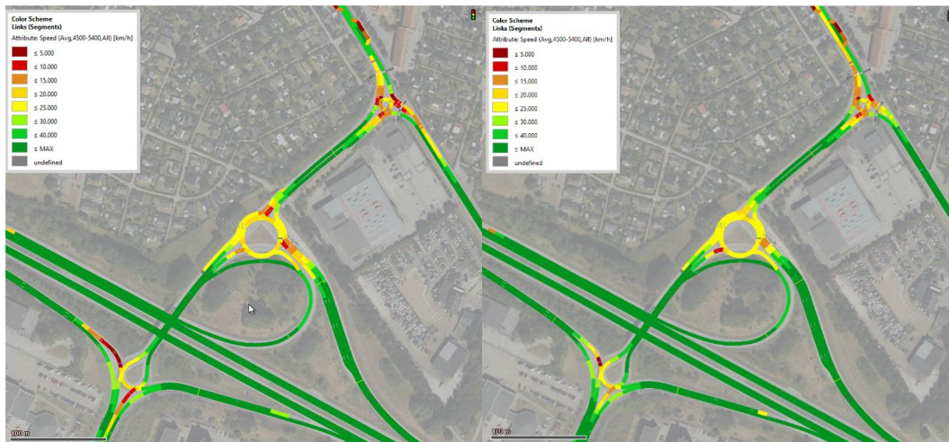
Figur 19. Fördröjningar i trafikplats Jägersro under förmiddagens maxtimma (till vänster) och eftermiddagens maxtimma (till höger) om den norra delen skulle byggas om till en cirkulationsplats. Trafikflödena avser prognosticerade flöden.
