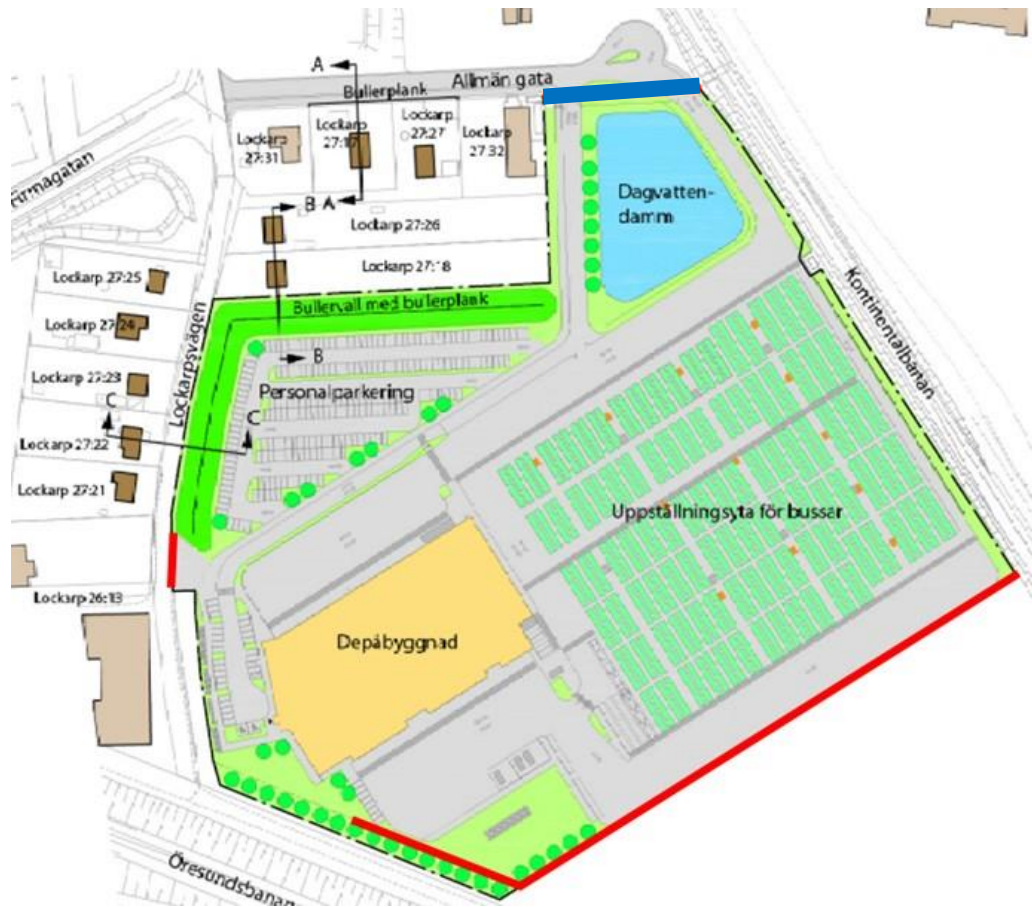
Figur 8 Illustration över planområdet. Blå linje redovisar den primära evakueringsvägen. Röda linjer redovisar sträckor där en extra utgång/grind kan placeras för att möjliggöra en evakuering. Detaljplanen möjliggör detta. Var grinden placeras är en fråga för den fortsatta projekteringen.
