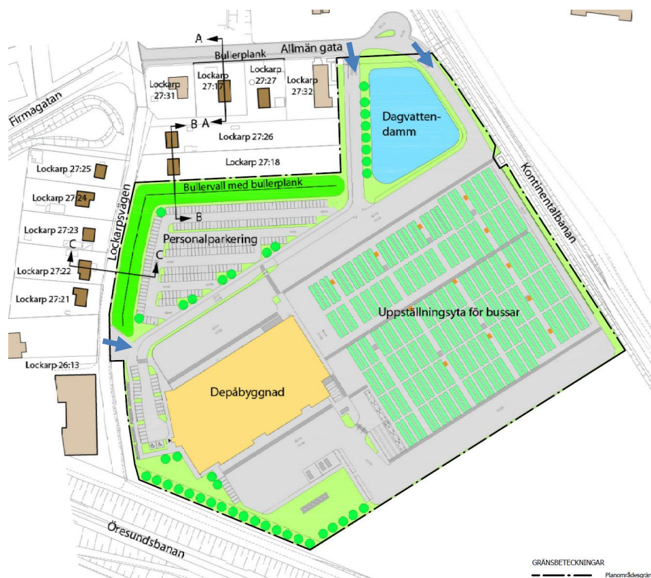
Figur 7 I ovan illustration redovisas var räddningsvägarna inom planområdet ansluter till omgivande gator (blå pilar).
