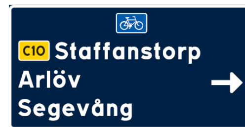
Figur 8 Exempel på vägvisning med skyltning och vägmarkering. Till höger dirigerande vägvisning som placeras i korsning där vägval görs (se orange figur i korsning). Till vänster illustreras princip för förberedande vägvisning som målas i cykelbana inför vägval. Vägmarkering av numrering används även för att bekräfta att supercykelvägen fortsätter efter vägvalet, som i fallet efter vänstersväng nedifrån i bild.
