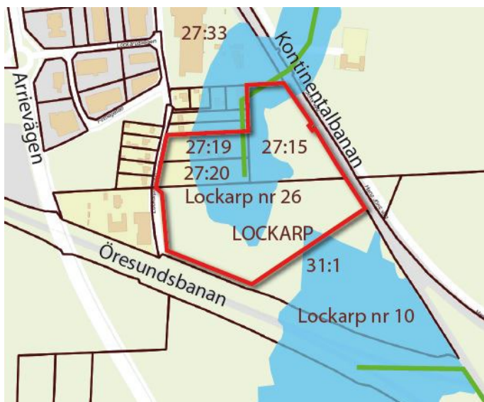
Figur 28 Dikningsföretagen Lockarp nr 26 och Lockarp nr 10. Diken visas som gröna linjer. Båtnadsområden visas som blå ytor. Planområdesgränserna visas som röd linje.
