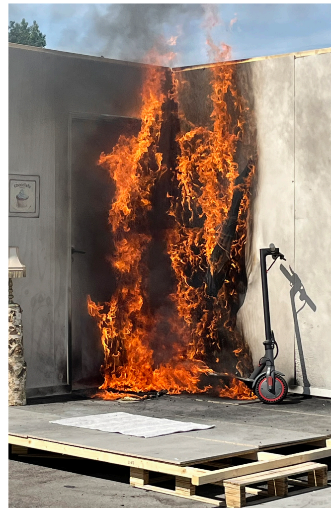
Simulering av batteribrand
