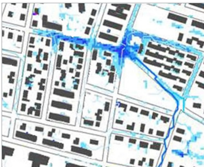
Figur 17. Exempel på marköversvämningskarta med flödesvägar. Den högra figuren visar hur en parkyta kan användas för att hantera skyfall. Illustration: Amanda Erlingsson Lundgren
