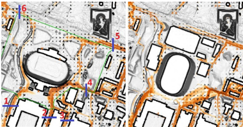
Flödesvägar vid skyfall i Stadionområdets norra del före och efter exploatering. F1 till F3 är flöden in i området och F4 till F6 är flöden ut ur området.
