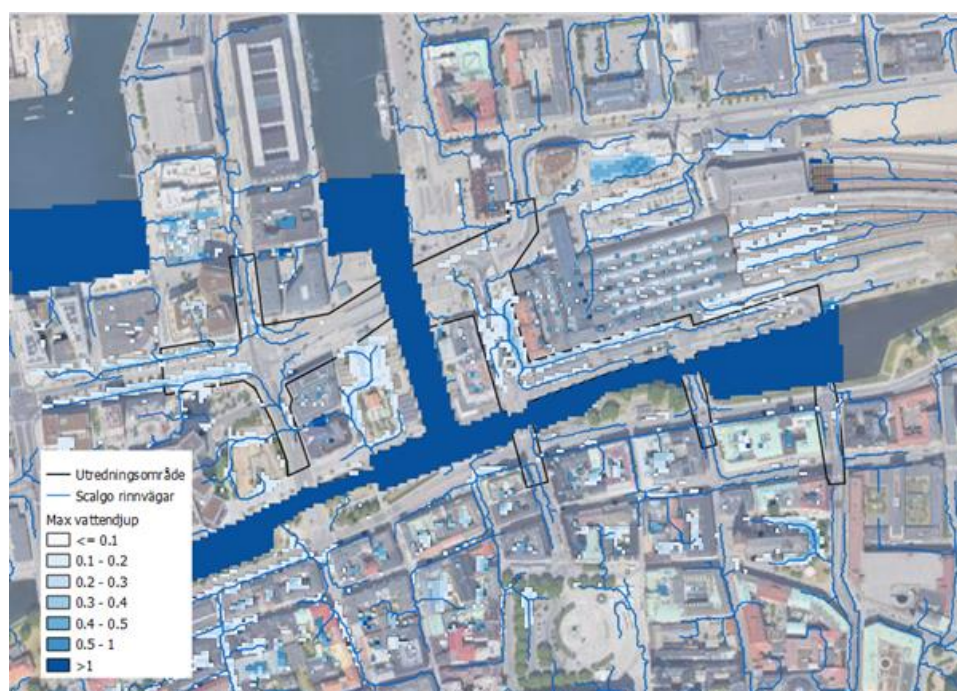
Figur 130. Resultat över maximalt djup från Malmö stads skyfallsmodell över ett 6-timmars 100-årsregn med klimatkfaktor 1,3. Vattendjup under 0,1 m visas inte (Malmö Stad, 2019). Resultatet visas tillsammans med ytavrinningsvägar från SCALGO
