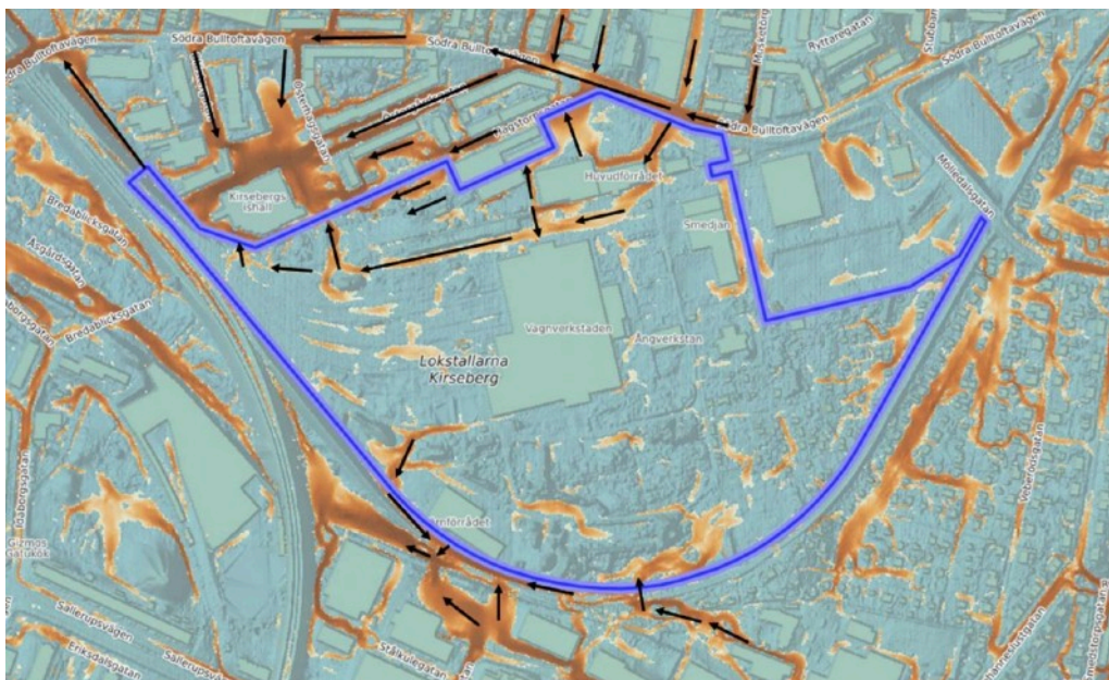
Diagram över befintliga rinnvägar. Vattenflöde visas i orange och flöde mindre än 5 l/s/ha redovisas inte. Generella flödesriktningar visas med svarta pilar.
